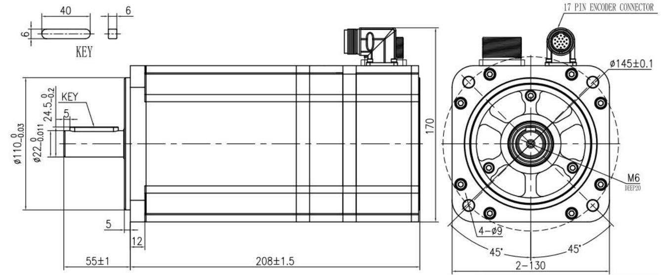
2.3.30 SMC130D-0150-30AAK-4DKR(130 法兰, 1.5KW, 不带抱闸, 增量式编码器)
