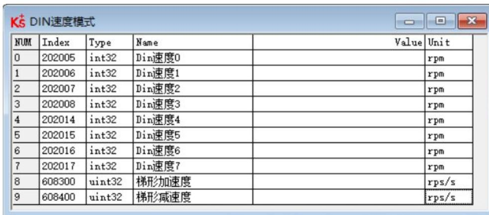
图 5 - 4 IO “DIN 速度模式” 窗口
