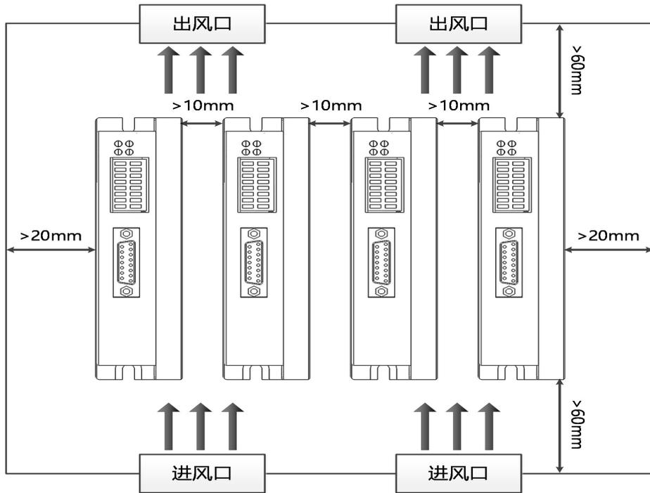
图 2-12 FD1x3 驱动器安装间隔
