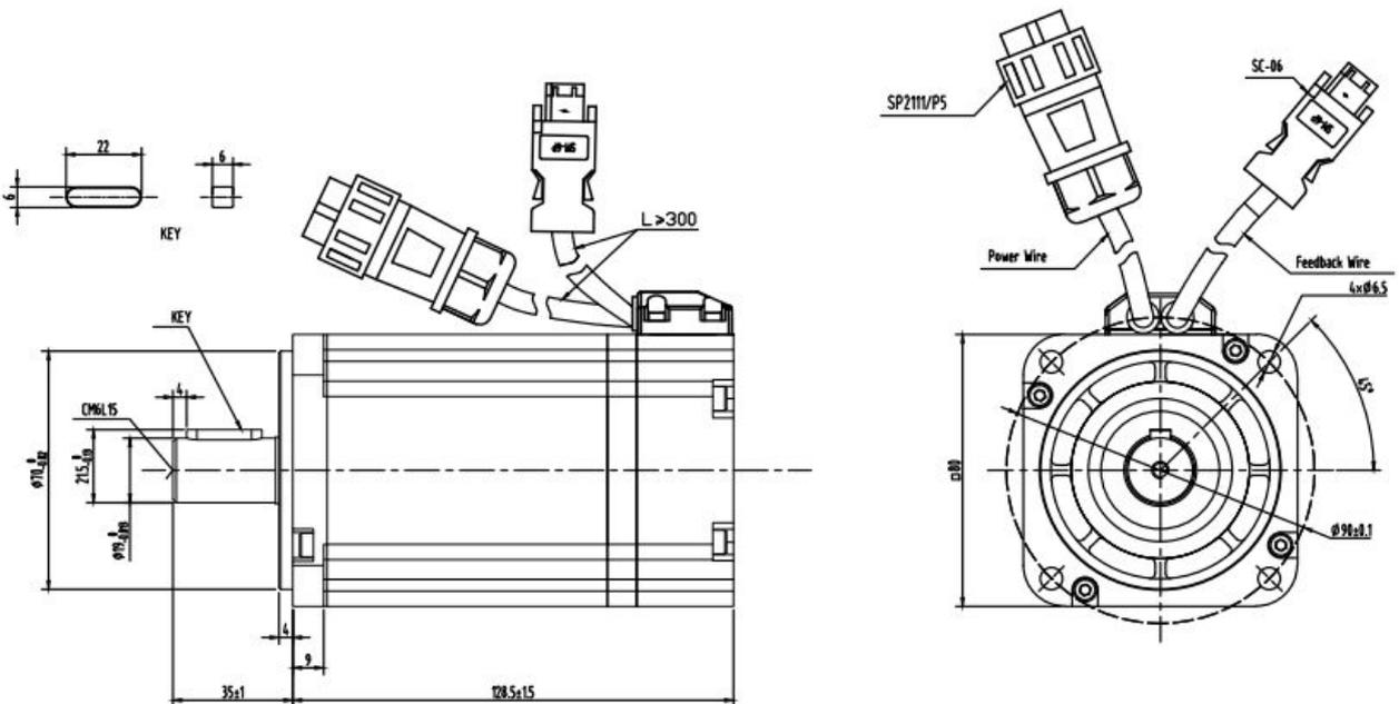
2.3.23 SMC80S-0075-30MBK-3DSU(80 法兰, 750W, 带抱闸, 磁电编码器)
