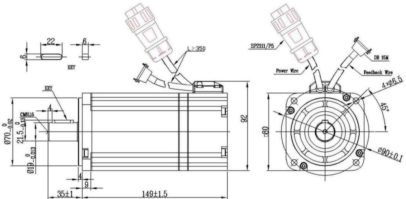
2.3.21 SMC80S-0075-30ABK-3DKH(80 法兰, 750W, 带抱闸, 增量式编码器)
