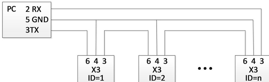
图 9 - 4 多机级联接线方式
