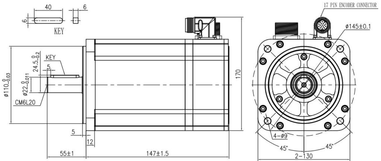
2.3.29 SMC130D-0120-30ABK-4DKR(130 法兰, 1200W, 带抱闸, 增量式编码器)
