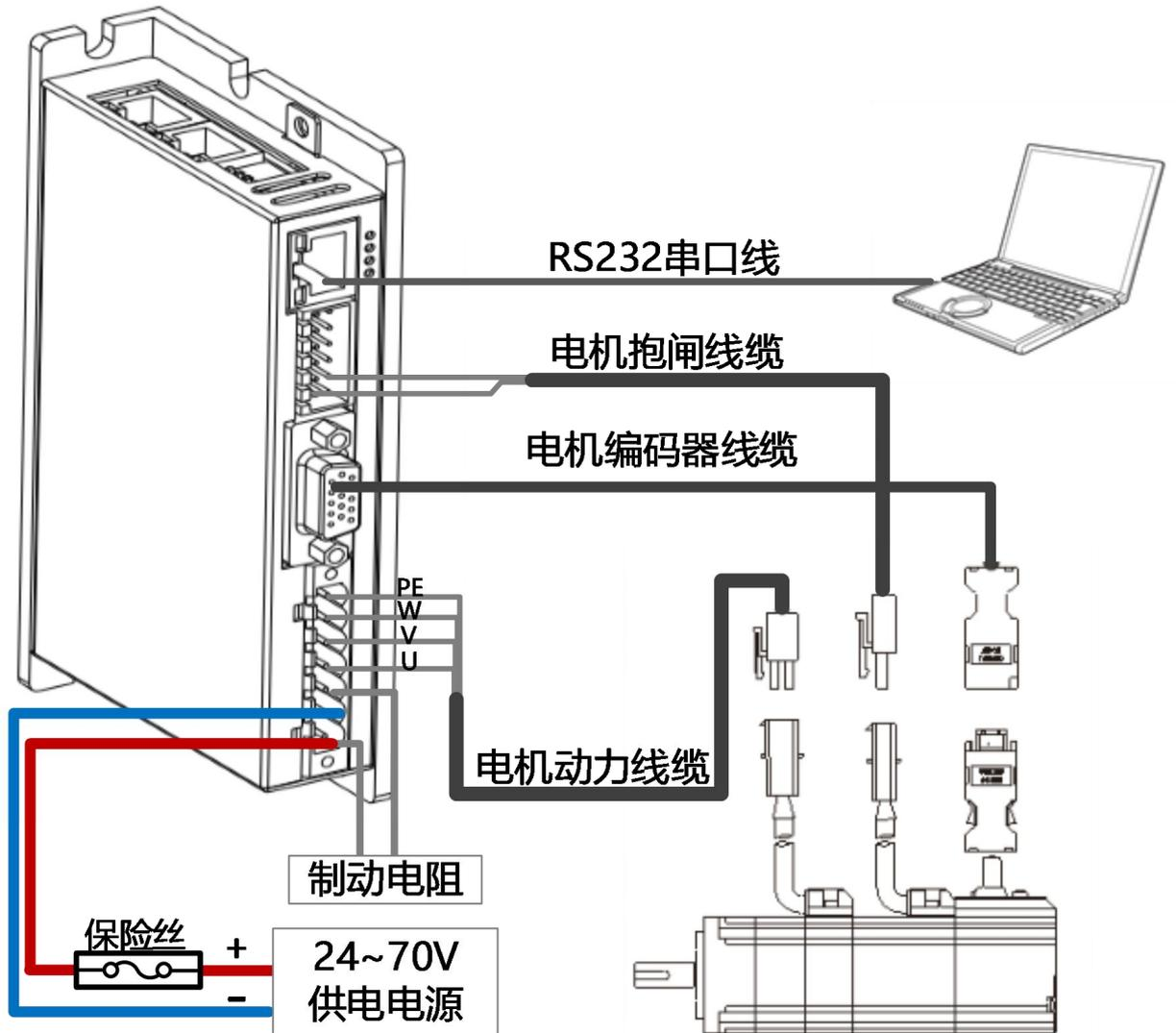
图 3-7 FD114S/FD124S 驱动器外部接线图
