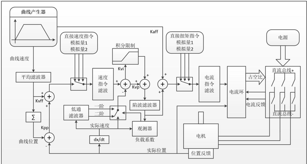
图 6-1 伺服系统控制结构框图
