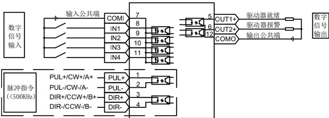
图 3 - 13 FD1x4S-□A-000 驱动器控制接线图
