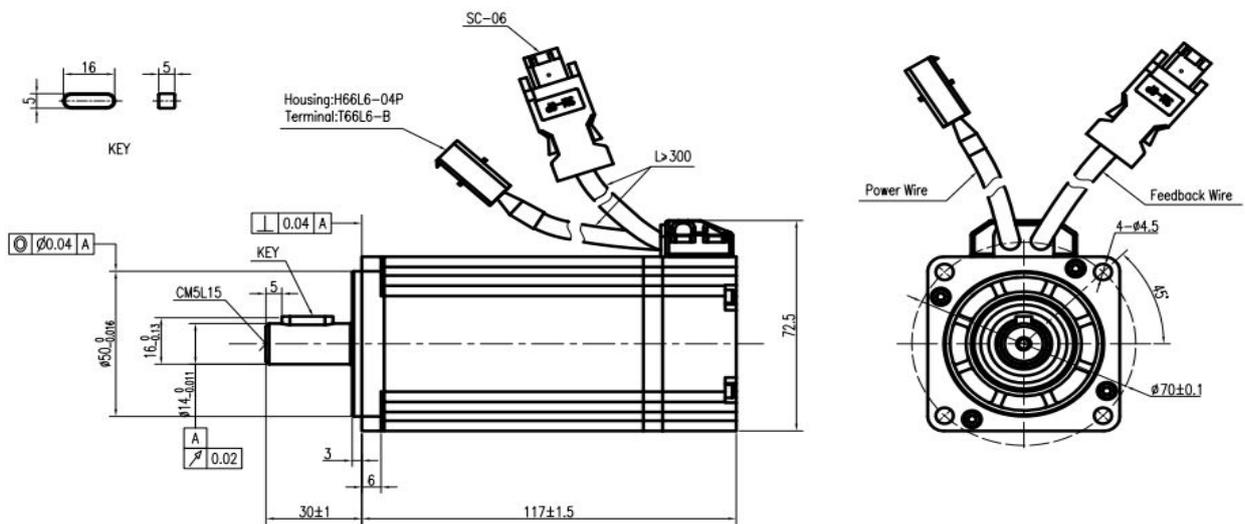
2.3.13 SMC60S-0040-30MBK-3DSU(60 法兰, 400W, 带抱闸, 磁电编码器)
