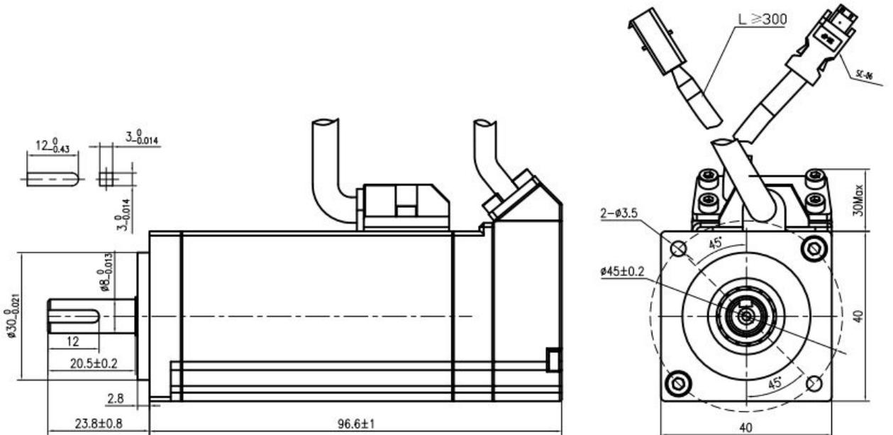
2.3.3 SMC40S-0010-30MBK-5DSU(40 法兰, 100W, 带抱闸, 磁电编码器)
