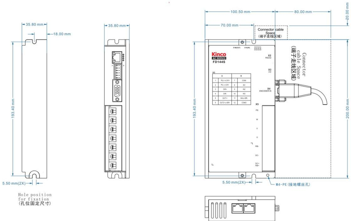
图 2-10 FD144S-E□驱动器尺寸图
