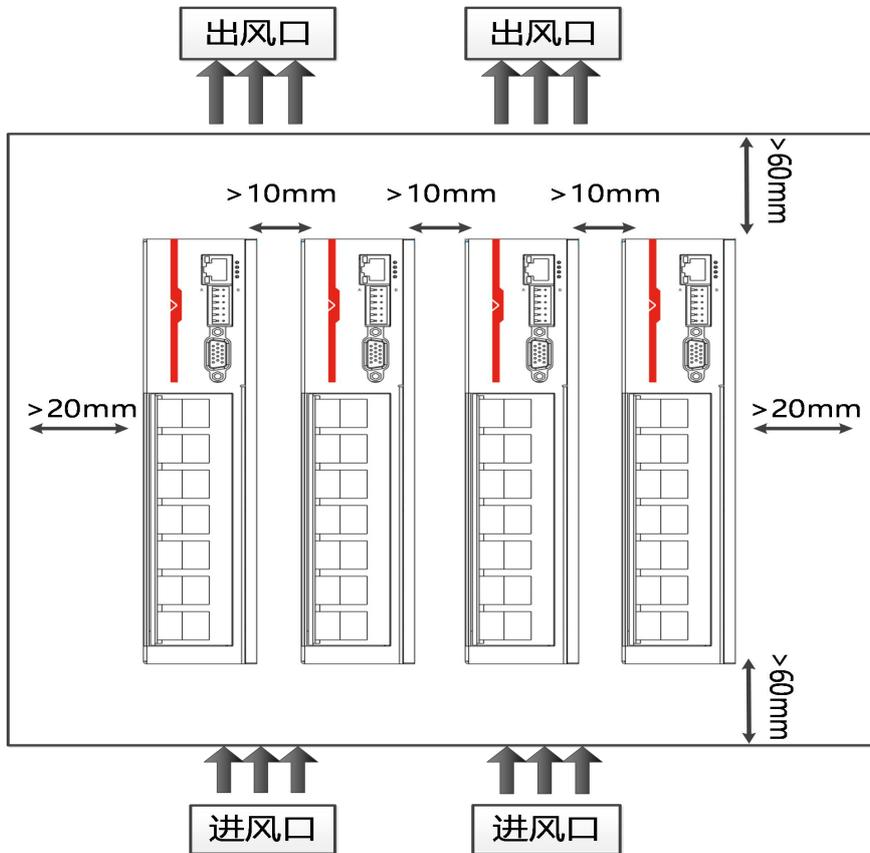
图 2-15 FD164S 驱动器安装间隔
