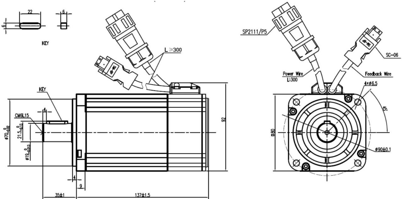
2.3.25 SMS80S-0075-30K BK-3DKU(80 法兰, 750W, 带抱闸, 绝对值编码器)
