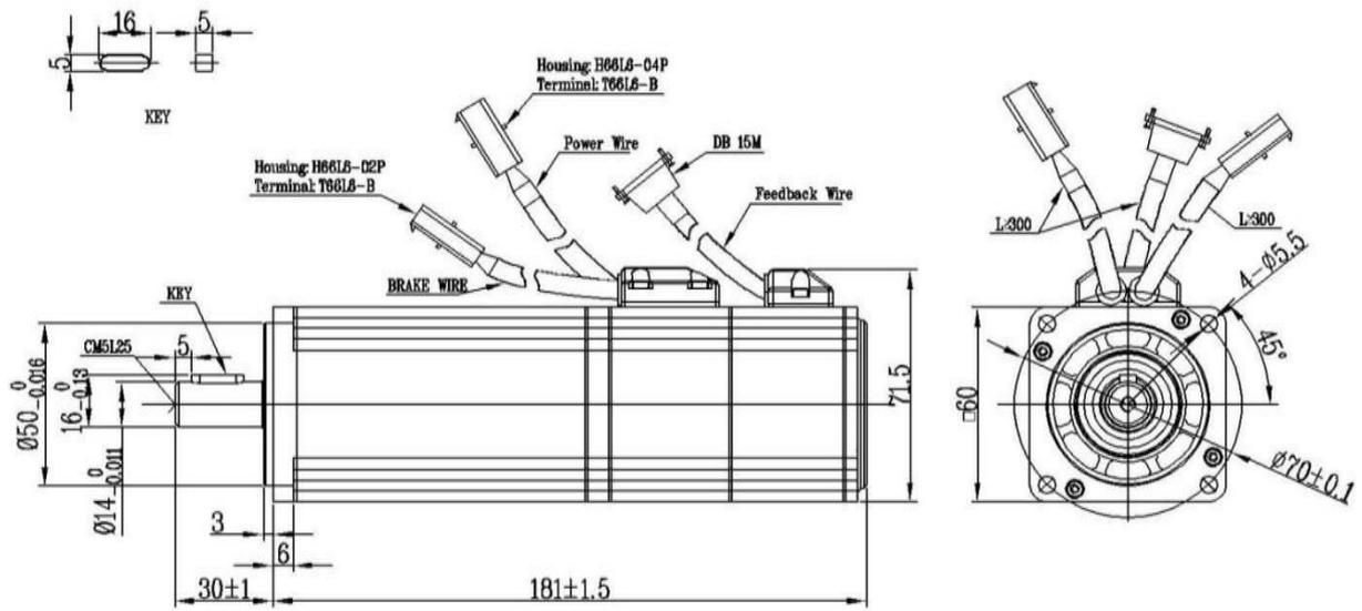
2.3.12 SMC60S-0040-30MAK-3DSU(60 法兰, 400W, 不带抱闸, 磁电编码器)
